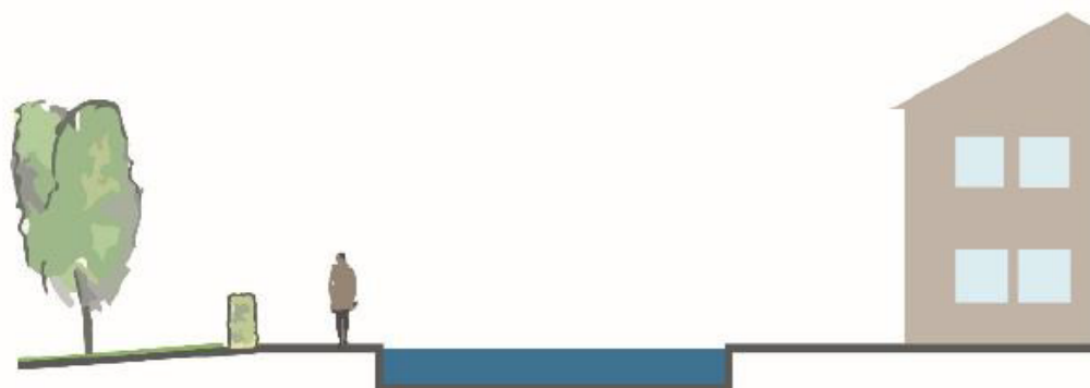
Figur 10. Bilden visar en nedsänkt väg som därmed också fungerar som skyfallsled vid extrema regn.
