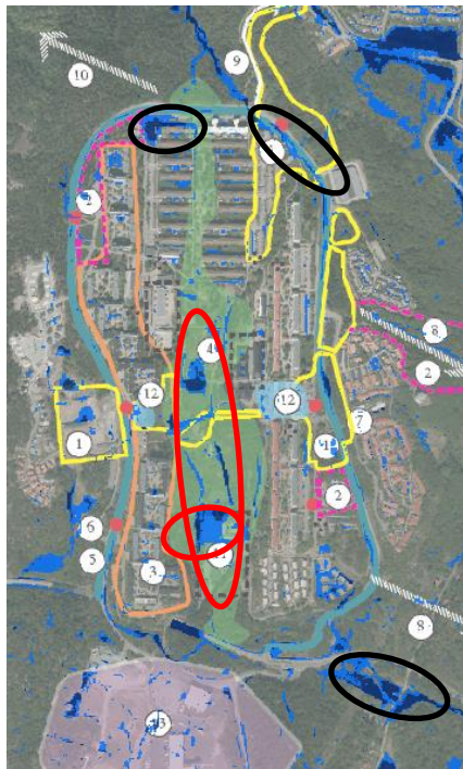
Figur 14. Svarta cirklar visar områden där vattenmängder samlas i befintlig bebyggelse eller infrastruktur. Den stora röda cirkel markerar yta som är lämplig för hantering av vatten och ska reserveras för skyfallslösning i programmet. Den mindre röda cirkeln (i den stora) markerar plats lämplig för reningslösning som delvis kan kombineras med skyfallsytan.
