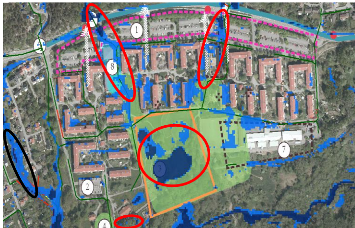
Figur 18. Svart cirkel visar områden där vattenmängder samlas i befintlig bebyggelse eller infrastruktur. Den röda cirkeln i söder visar en yta som är lämplig för hantering av vatten och bör pekas ut som yta för skyfall i programmet. De två röda cirkelarna i norr visar hur vattnet flödar genom befintlig bebyggelse och om nybyggnation ska ske inom dessa områden bör yta reserveras för att hantera flödena. Den lilla cirkeln i söder visar ungefärlig plats för möjlig placering av storskalig reningsanläggning.
