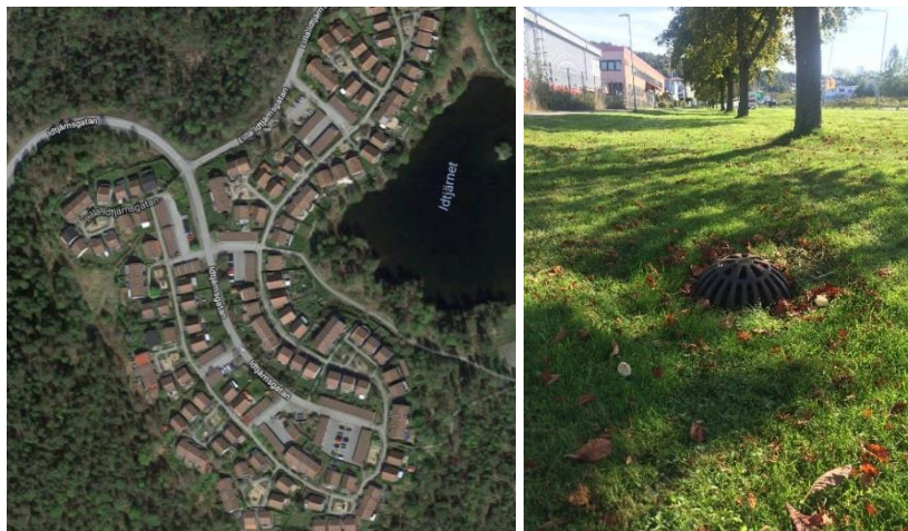
Figur 5 Bilden till vänster visar villaområdet vid Idtjärnet i Rannebergen som är ett typiskt exempel på en mindre belastad yta. Bilden till höger visar exempel på en översilningsyta som är en lämplig reningslösning i detta typ av område.
